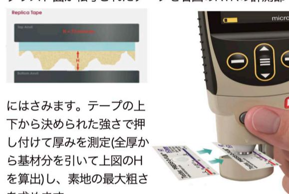
にはさみます。テープの上下から決められた強さで押し付けて厚みを測定(全厚から基材分を引いて上図のHを算出し)、素地の最大粗さを求めます。
