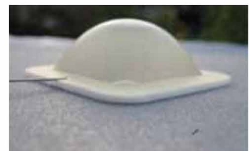
パッチ内への水の注入
