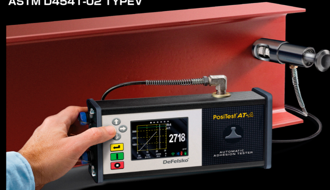
全自動プルオフ式付着性試験機 ポジテストAT-A20 : ¥408,300(税別本体)
