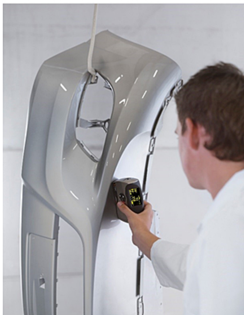
写真-1 光沢度測定の実例(車のバンパー)
