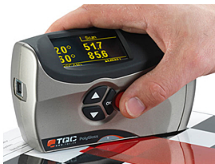
写真-2 3角度測定に対応した光沢計の例
