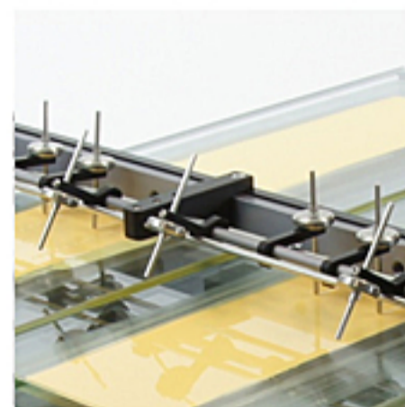
第8図 自動アプリーターに付加された機能で乾燥時間を測定している例
